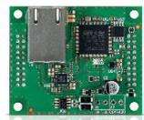
Extension Ethernet pour le module de communication universel GSM/GPRS/2G/SMS SA-GSM-X. • Module enfichable rendant la transmission Ethernet câblée possible en tant que support primaire, support back-up ou solution DUAL de transmission de rapports
