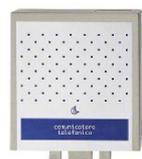
SINTECOM-4 transmetteur vocal autonome • Entrées: 4 • Messages: 4 • N° de téléphone: 6 • Consommation: 115mA • Dimension boîtier (LxHxD): 140 x 110 x 50 mm • la programmation se fait en connectant un téléphone DTMF
